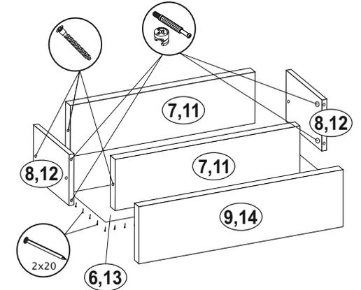
Ручку на створки (9,14) приворачивать винтами М4х14/16.
